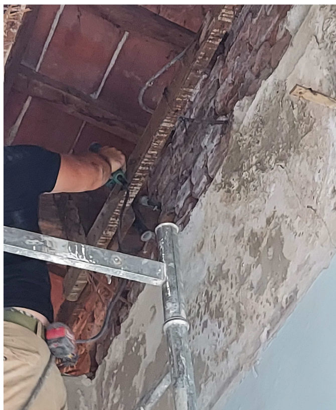
Ubicazione e risultanze delle indagini resistografiche
